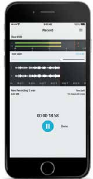
Tela de gravação do MOTIV Formato .wav de 24-bit/48 kHz, ajustes de ganho em tempo real, medição de alta resolução
