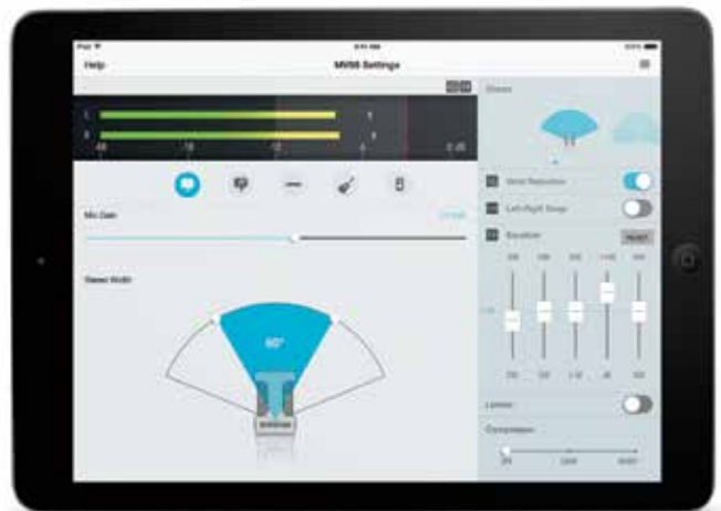
Tela de configurações avançadas do MV88 Seleção de padrão polar, EQ de 5 bandas, redução de ruído de vento, compressor, limitador, alteração de canal esquerdo/direito
